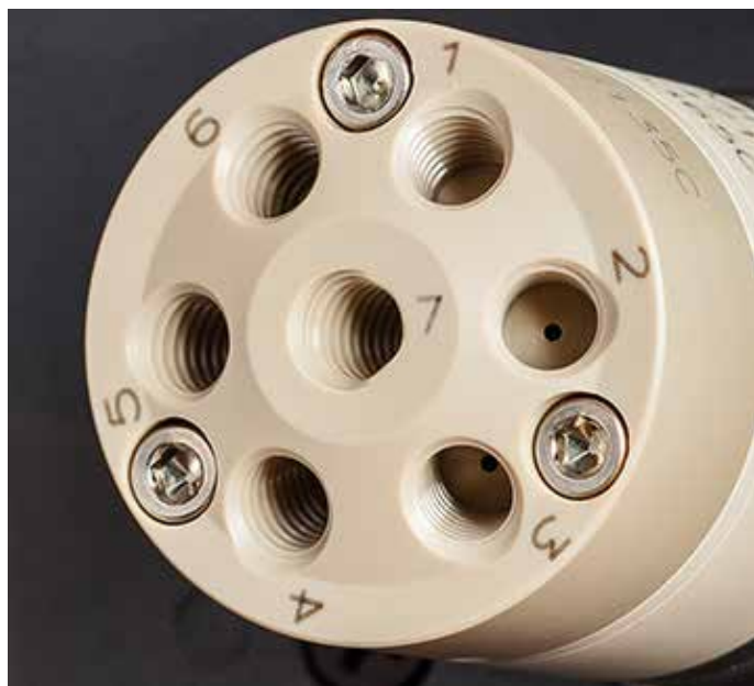
Рис. 6. Отчетливая маркировка портов клапана AVS.
