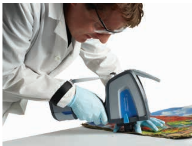
Легкий портативный ИК-Фурье спектрометр серии 4300 имеет встроенный аккумулятор и позволяет выполнять измерения в любом положении
