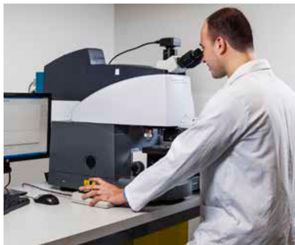
На рисунке изображен ИК-Фурье-микроскоп и система построения ИК-изображений Cary 620 с
